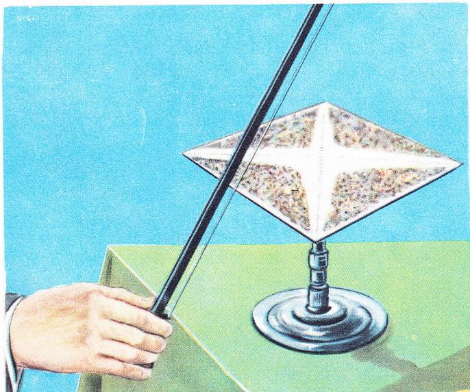
*Le physicien allemand Chladni (1756-1827) parvint à rendre visibles les vibrations d'une plaque métallique. En effet, en répandant du sable sur la dite plaque et en la faisant vibrer afin d'émettre un son, il constata qu'à sa surface le sable se disposait suivant des lignes bien dessinées,*
